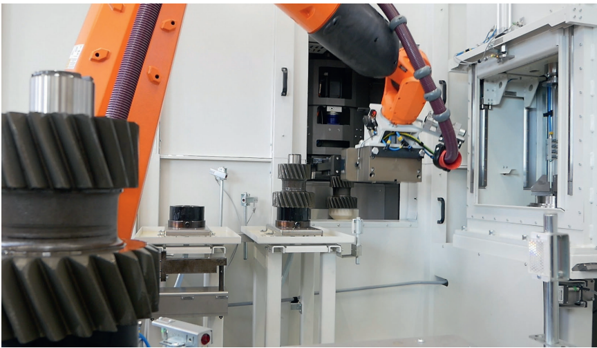
1 Von der manuellen Beladung über ein einfaches Palettentransportband bis hin zur hier gezeigten komplexen Roboterlösung bietet das Verzahnungszentrum KNG 350 des Herstellers Kapp Niles die passende Flexibilität beim Beladen von Bauteilen © Kapp Niles
