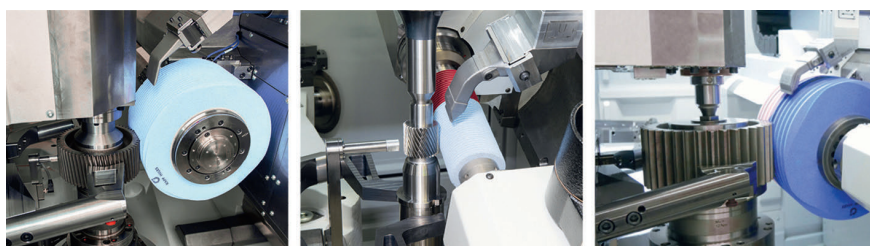
3 Je nach Anwenderbedarf: die unterschiedlichen Werkzeugachsen der Serie KNG 350
